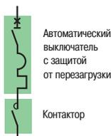
Автоматический выключатель с защитой от перегрузки
