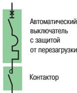
Автоматический выключатель с защитой от перегрузки
